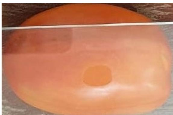
**Implementação do Software de Análise de Imagens:** Desenvolvemos um software na plataforma Windows, utilizando Python, OpenCV e NumPy. O software lê a imagem, localiza a deformação gerada pela lâmina do aplanador, identifica suas dimensões e calcula a firmeza do tomate.
