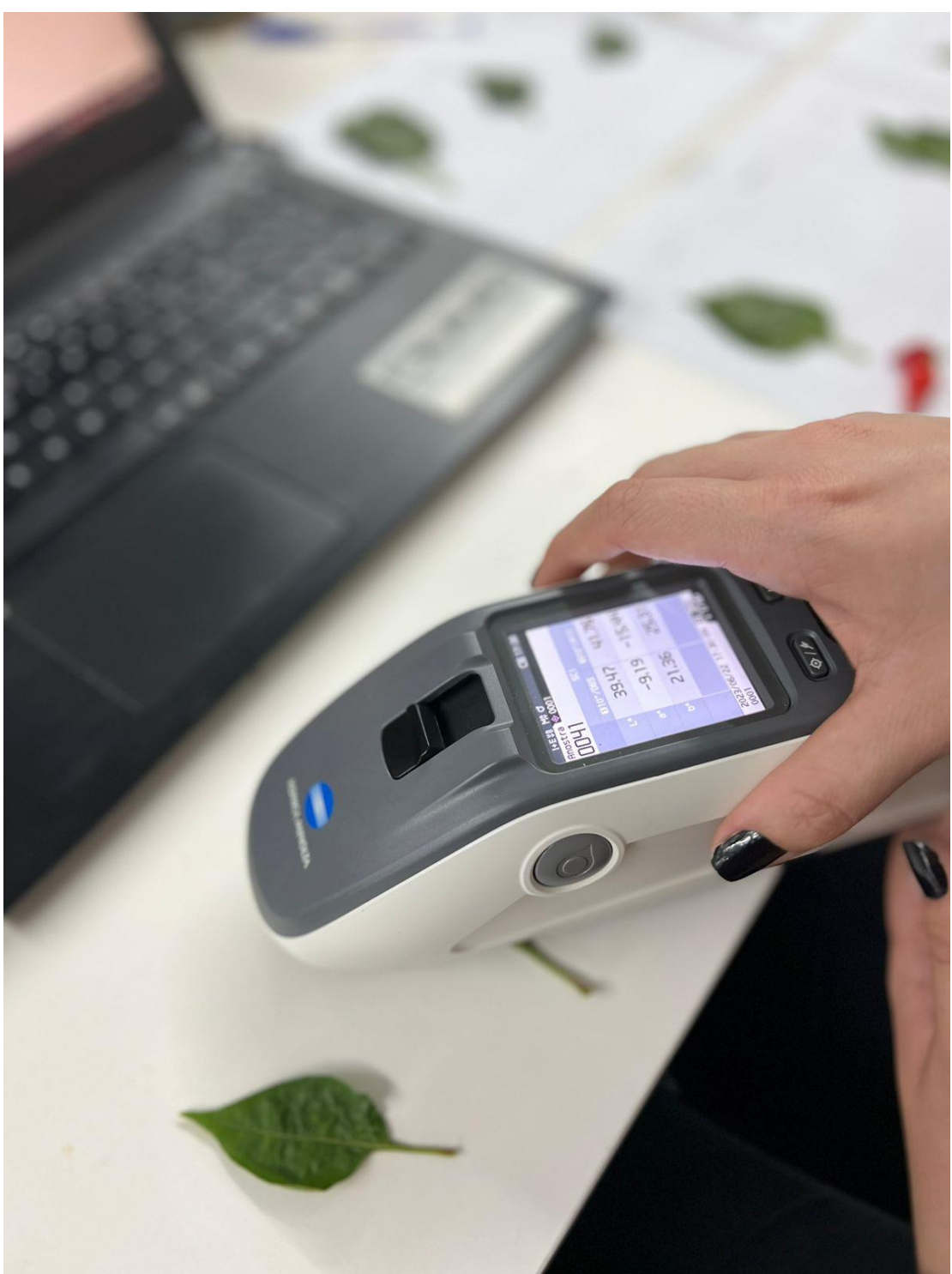
Figura 1 – Análise instrumental realizada utilizando o colorímetro Minolta CM-25d, em pimentas F8 10070 tratadas com PBZ.
