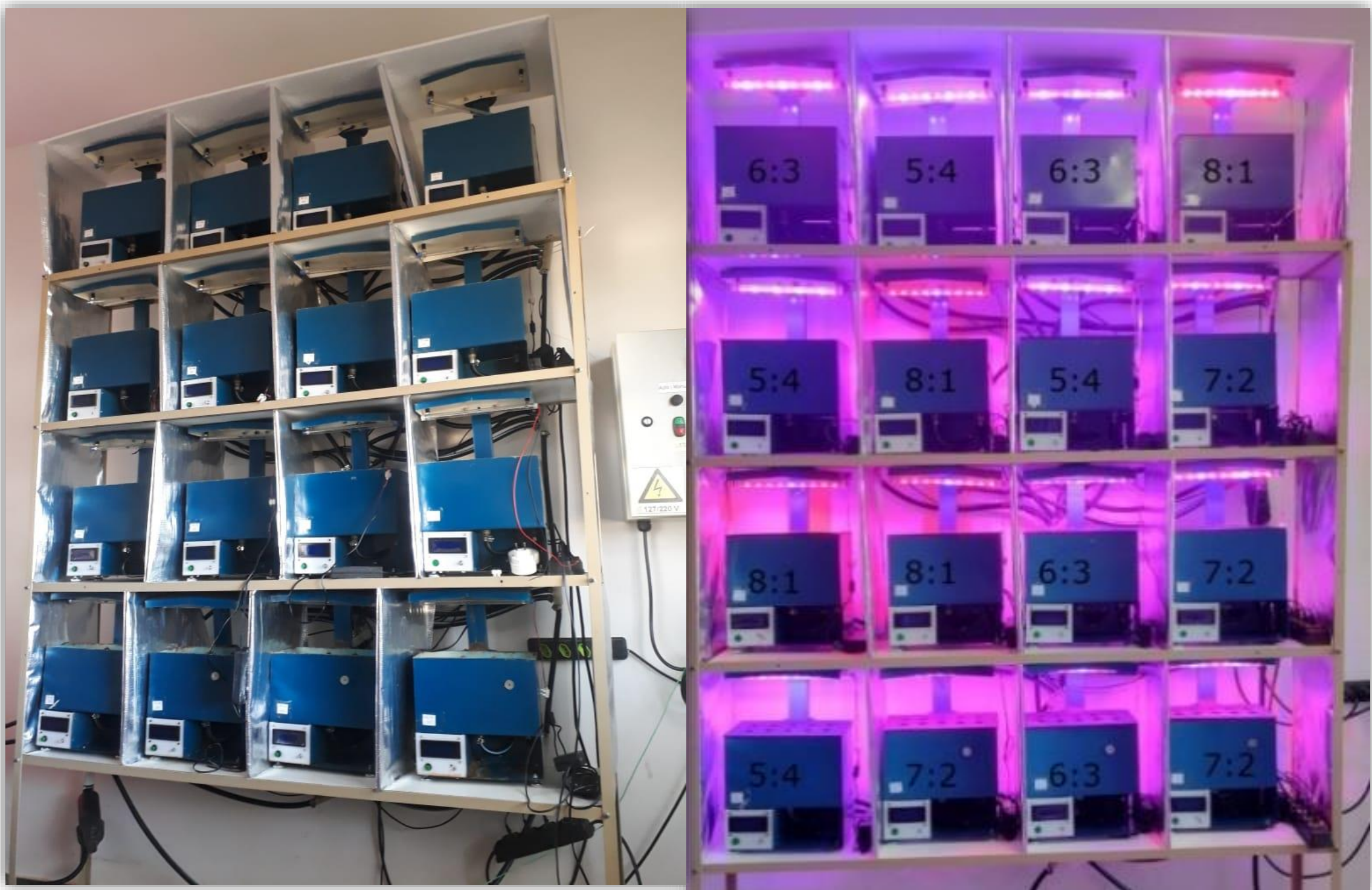
Figura 1. Estante com SAP distribuídos e isolados com LEDs desligados (a), estante com aparelhos SAP distribuídos e isolados, com LEDs ligados (b), com tratamentos (5:4,6:3,7:2,8:1) e 4 repetições
